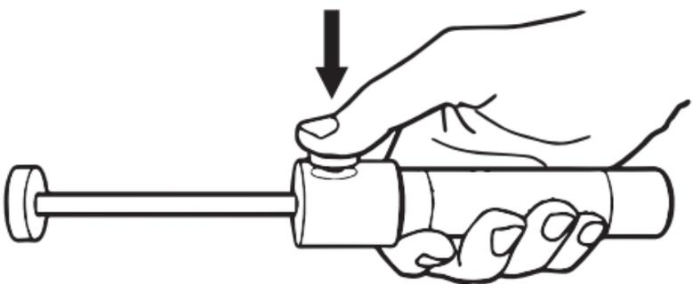
1. Das Gerät so in einer Hand halten, dass mit dem Daumen der Auslöseknopf [3] betätigt werden kann.
